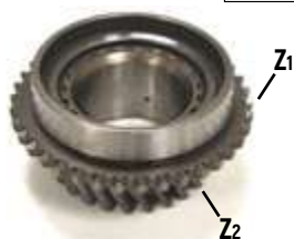
Шестерня КПП вторичного вала (5 передачи)
