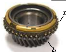
Шестерня КПП вторичного вала (5 передачи)
