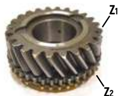
Шестерня КПП вторичного вала (3 передачи)
